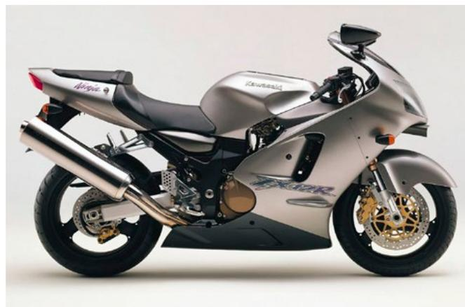
estava electronicamente limitada a 300km/h, apesar da sua cilindrada de 1.199cc produzir 161,2cv à roda, capazes de um arranque (0-100km/h) em apenas 2,59 segundos.
