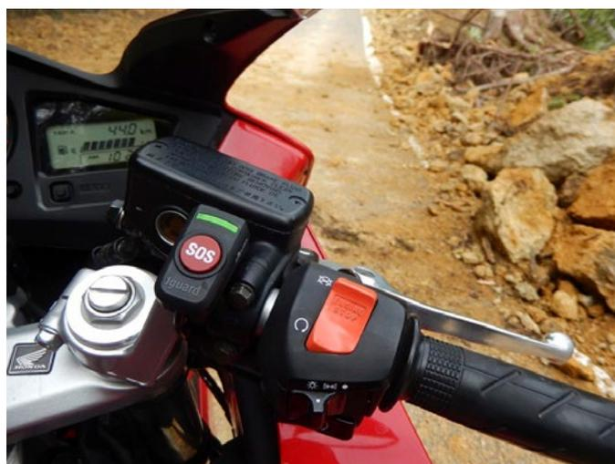
dente, se tiver o sistema dguard montado na sua moto, pode pedir o socorro das equipas de emergência de forma muito rápida e simples, bastando para isso premir o botão vermelho SOS, instalado no guiador da sua moto, durante alguns segundos. Chamadas inadvertidas através deste botão SOS podem ser canceladas num espaço de 15 segundos.
